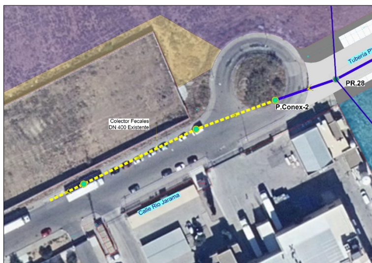
Conexión Suroeste a colector existente
